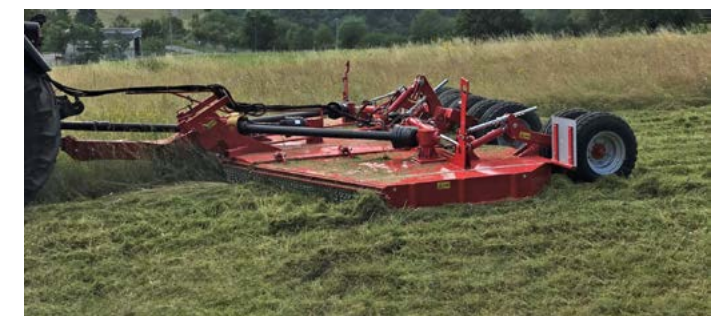
Mulčovač CONDOR s pracovným záberom až 8m
