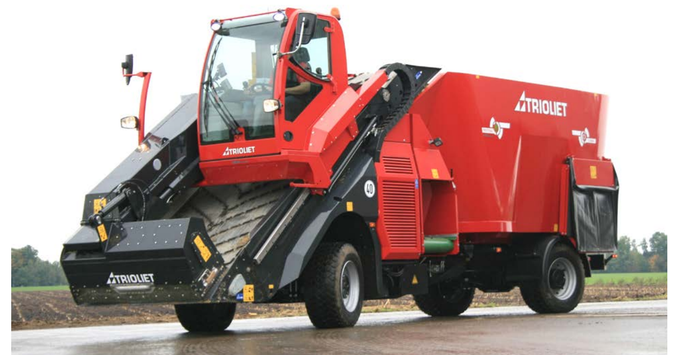
Jedinečný samochodný miešací kr̄mny voz TRIOLIET TRIOTRACK s vyberacím štítom, pre najväčší výkon krmenia
