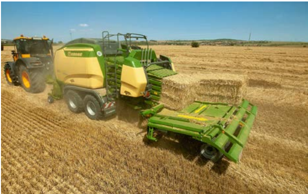
Riešenie BaleCollect - akumulačný vozík na optimalizáciu ukladania balíkov
