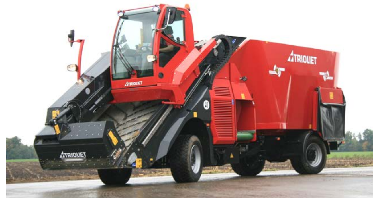
Jedinečný samostatný miešací kŕmny voz TRIOLIET TRIOTRAC s vyberacím štítom, pre najväčší výkon kŕmenia
