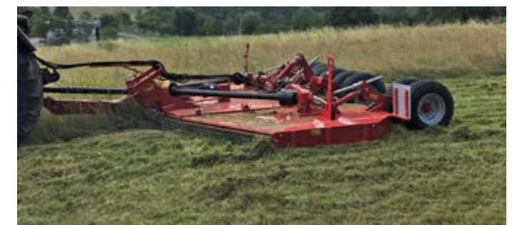
Mulčovač CONDOR s pracovným záberom až 8m
