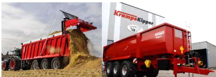
Náves s výtlačným systémom Krampe RamBody 900 a najväčší trojnápravový náves BiG Body 900 s objemom až 47 m 3
