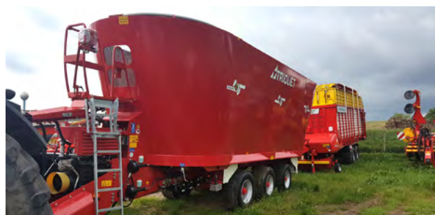
Najväčší krímny voz SOLOMIX 3 - vertikálne závitovky
