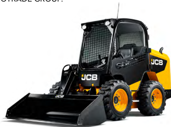
Jediný šmykom riadený nakladač s ramenom uloženým na pravej strane pre väčšiu bezpečnosť obsluhy
