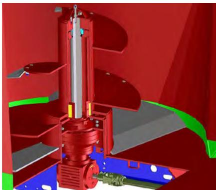
Vertikálny systém miešania s jednou závitovkou na kŕmnom voze SOLOMIX 1
