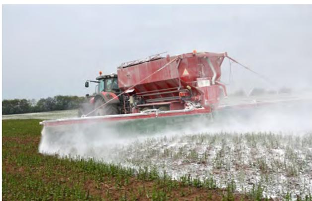
Variabilné a presné vápnenie pomocou KRAMPE SK 600
