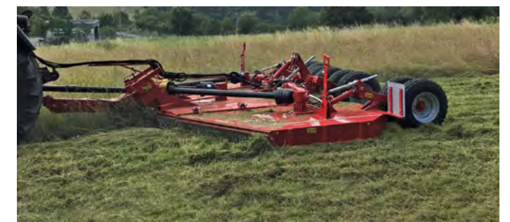
Mulčovač CONDOR s pracovným záberom až 8m
