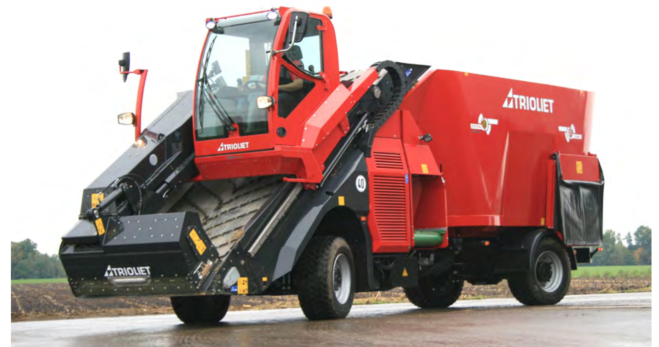
Jedinečný samostatný miešací krmný voz TRIOLIET TRIOTRAC s vyberacím štítom, pre najväčší výkon krmenia
