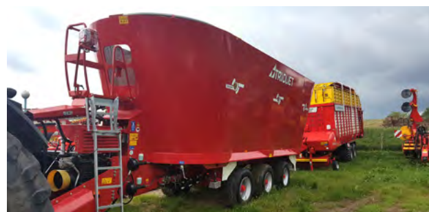
Najväčší krmný voz SOLOMIX 3 - vertikálne závitovky
