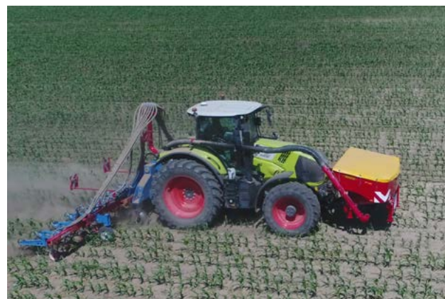
Možnosť súčasného plečkovania a prihnojovania na jeden prejazd v kombinácii Hatzenbichler a Väderstad
