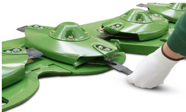
Žacia lišta KRONE - modulárny systém žacieho disku
