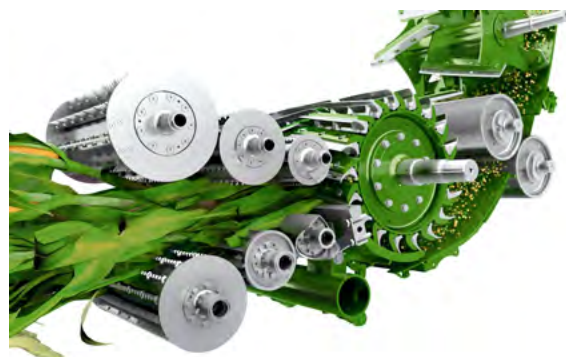
6 vkladacích valcov - jedinečný systém KRONE
