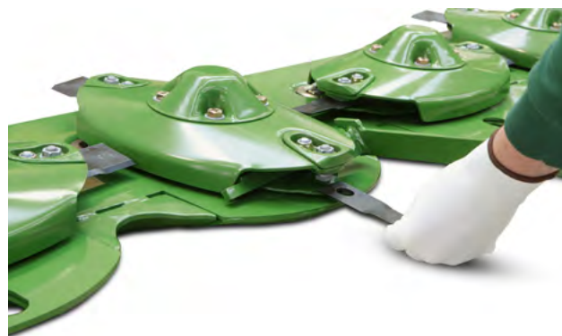
Žacia lišta KRONE - modulárny systém žacieho disku
