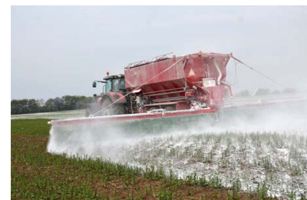
Variabilné a presné vápnenie pomocou KRAMPE SK 600
