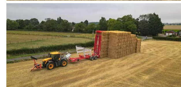
ARCUSIN - plne automatický návěs na zber a stohovanie balíkov
