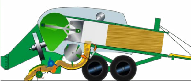
Unikátny variabilný plniaci systém KRONE
