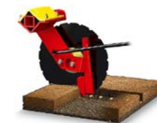
Výsevná pätkka na sejačke RAPID s prítlakom priemerne až 150 kg
