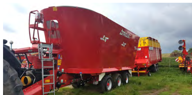
Najväčší kŕmny voz SOLOMIX 3 - vertikálne závitovky
