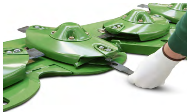
Žacia lišta KRONE - modulárny systém žacieho disku
