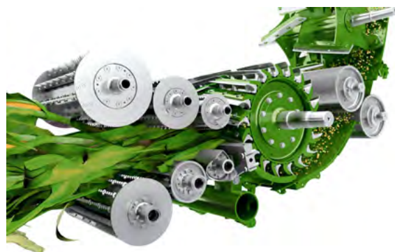
6 vkladacích valcov - jedinečný systém KRONE
