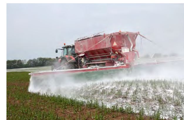
Variabilné a presné vápnenie pomocou KRAMPE SK 600
