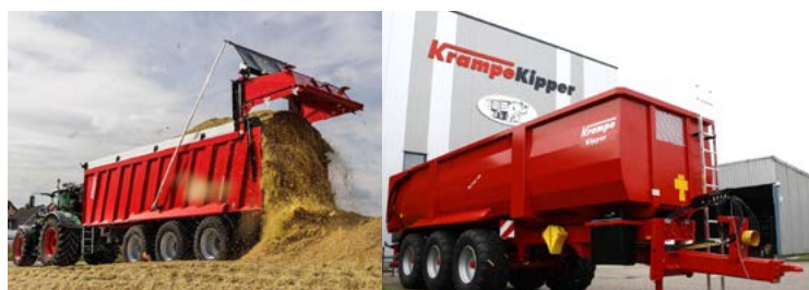
Náves s výtlačným čelom Krampe RamBody 900 s objemom až 52,3 m 3 a náves BiG Body 900 s objemom až 46,1 m 3
