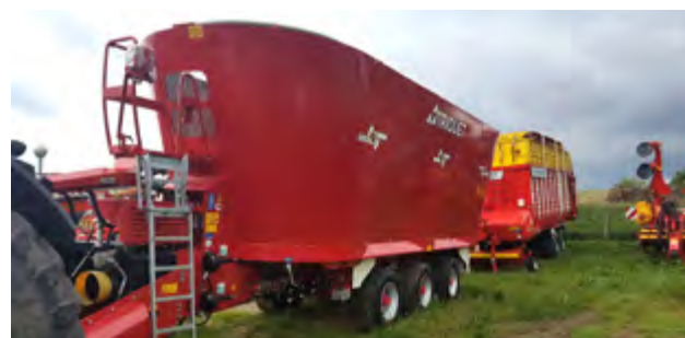
Najväčší krmný voz SOLOMIX 3 - vertikálne závitovky
