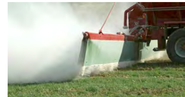
KRAMPE SK 600 - jediný na Slovensku vyrábaný stroj na variabilné a presné vápnenie
