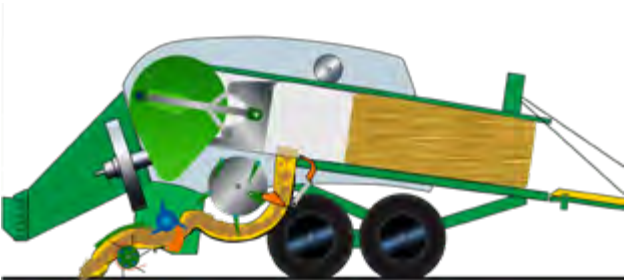
Unikátny variabilný plniaci systém KRONE
