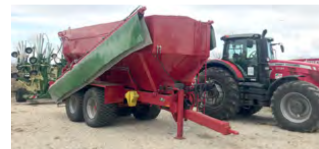
KRAMPE SK 600 - jediný na Slovensku vyrábaný stroj na variabilné a presné vápnenie
