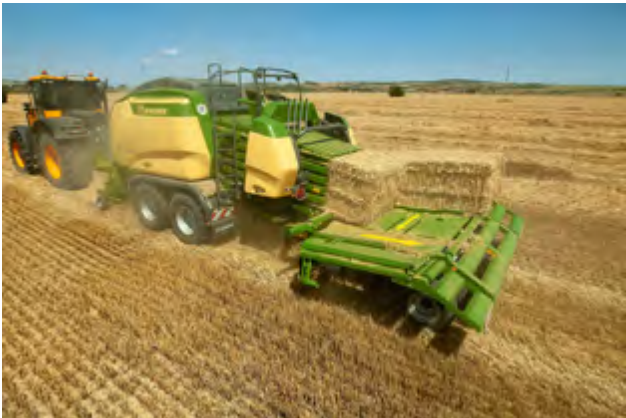
Riešenie BaleCollect - akumulačný vozík na optimalizáciu ukladania balíkov
