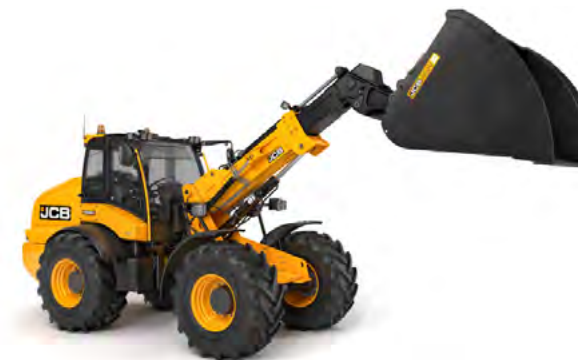
JCB Telemaster - jedinečný kĺbový nakladač s výsuvným ramenom
