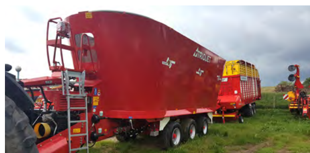
Najväčší krmný voz SOLOMIX 3 - vertikálne závitovky
