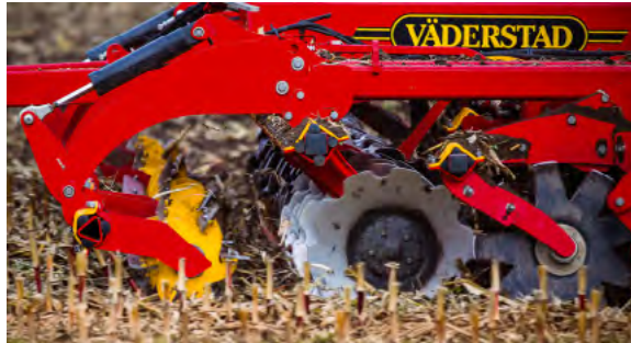
Carrier s čelným nožovým rotorom Crosscutter Knife
