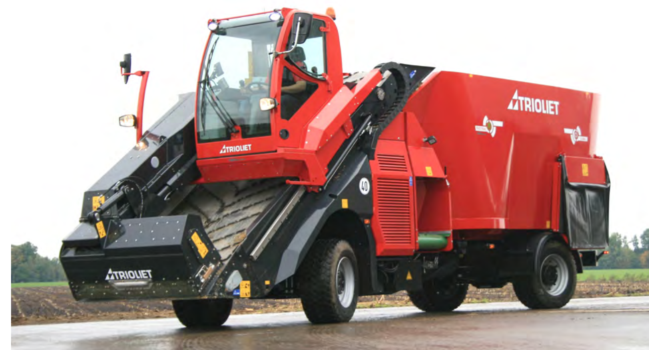
Jedinečný samostatný miešací krmný voz TRIOLIET TRIOTRAC s vyberacím štítom, pre najväčší výkon krmenia
