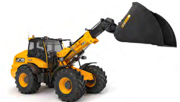
JCB Telemaster - jedinečný kĺbový nakladač s výsuvným ramenom
