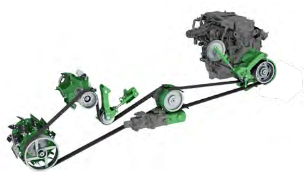
Rezačky KRONE, priamy pohon od motora - žiadne straty v prevodoch, jednoduchá prevádzka a kontrola
