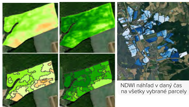
Príklad zobrazenia SAVI indexu na vybranej parcele vo vybraných dátumoch. Horný obrázok znázorňuje aktuálny satelitný snímok, dolný obrázok zobrazuje softvérom vygenerovanú odporúčenú aplikačnú mapu, napríklad na variabilné hnojenie dusíkom
