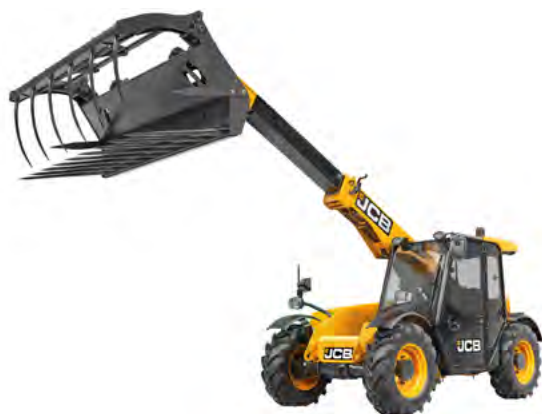
Kompaktný model JCB 525-60 AGRI Plus vybavený vidlami s pridržiavačom na hnoj
