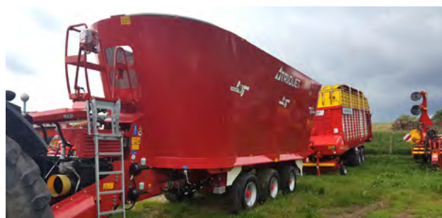
Najväčší krímny voz SOLOMIX 3 - vertikálne závitovky
