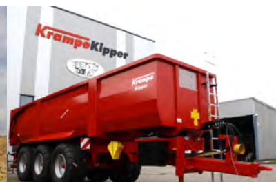
Náves s výtlačným čelom Krampe RamBody 900 s objemom až 52,3 m 3 a náves BiG Body 900 s objemom až 46,1 m 3
