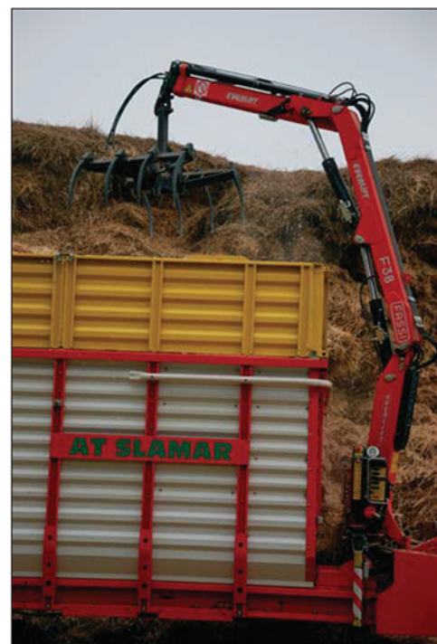
Dôležitou časťou AT SLAMÁR je hydraulická ruka známej značky FASSI.
