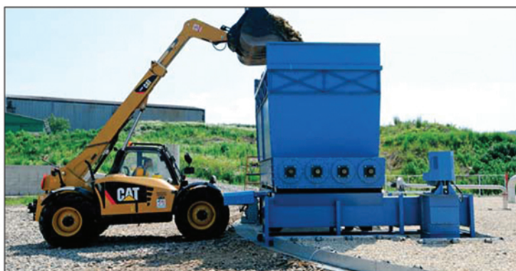
Plnenie jedného z dvoch fermentorov kukuričnou silážou. Celkovo denne spotrebujú 35–50 t.
