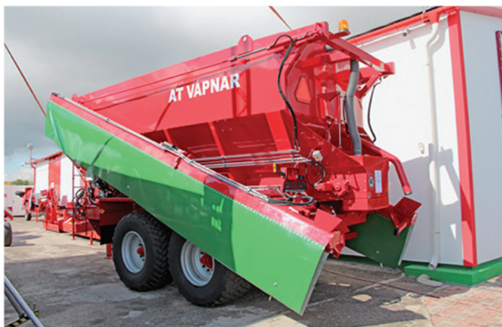
K hlavným bodom dvojdňového programu bolo pokrstenie nového špeciálneho aplikátora AT VÁPNDAR, ktorý bol vyvinutý a vyrobený pre variabilnú aplikáciu vápna do pôdy.
