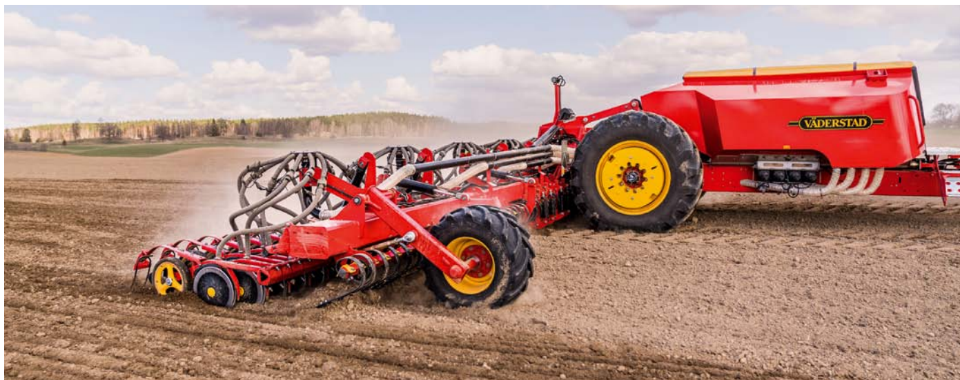
Inspire 12000 so záberom 12 m má zásobník pre osivo a hnojivo v objeme až 7 200 l.
