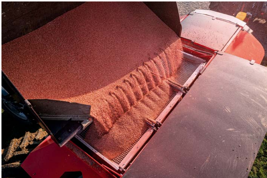
Zásobník s výškou iba 2,1 m umožňuje plnenie aj čelným nakladačom traktora.
