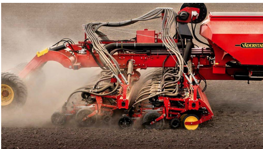
Prístupnosť k prednému radu pri výmene výsevných kotúčov a počas servisu uľahčuje posun zadnej sekcie o 55 cm.
