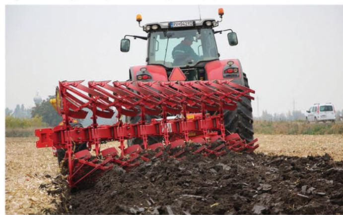
Pluh Pöttinger 6.50 Servo s prútovými odhrňovačkami je vybavený systémom dočasenia zadnej nápravy traktora.
