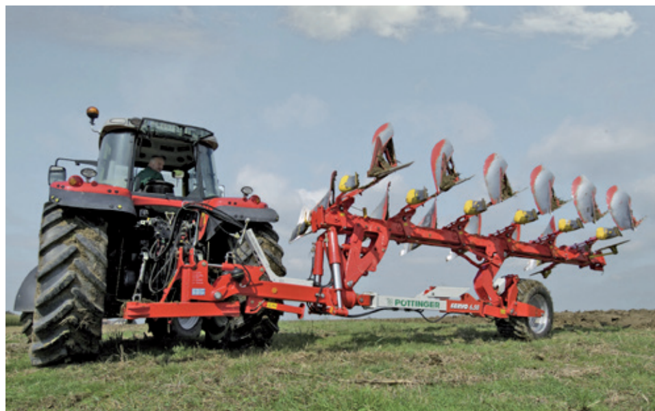
Servo 6.50 s jedinečným systémom Traction Control – minimalizácia preklzu s úsporou PHM do 4 l/ha.
