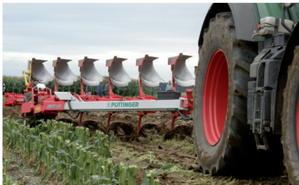
SERVO 6.50 v nasadení pri práci. Pluh je vybavený plynulou zmenou záberu s označením PLUS.
