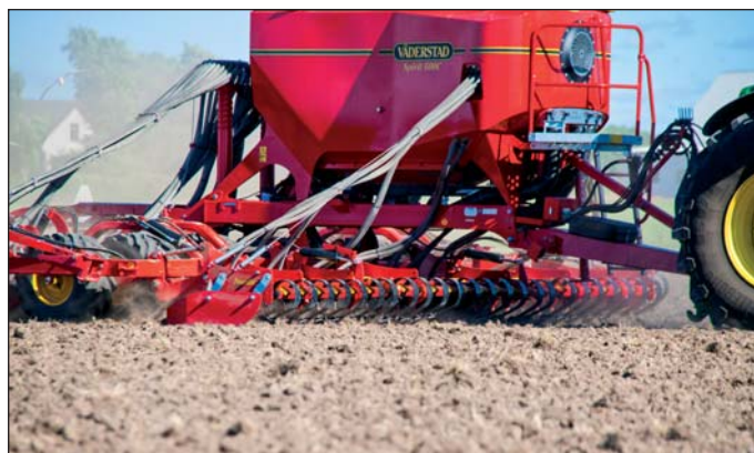
Hadice v prednej časti stroja Spirit 600C dopravujú hnojivo k mechanizmu, ktorý s vysokou presnosťou ukladá hnojivo aj vo veľmi ťažkých pôdach. Tiež sa tento stroj vyznačuje veľmi presným ukladáním osiva i pri vyšších rýchlostiach.
