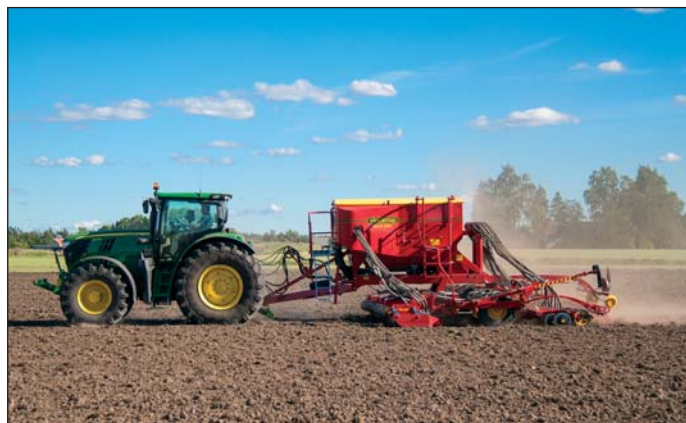
Spirit 600C Nordic má zásobník s objemom 5000 l a pracovný záber 6 m, čo vyžaduje príkon ťažného prostriedku od 175 k.
