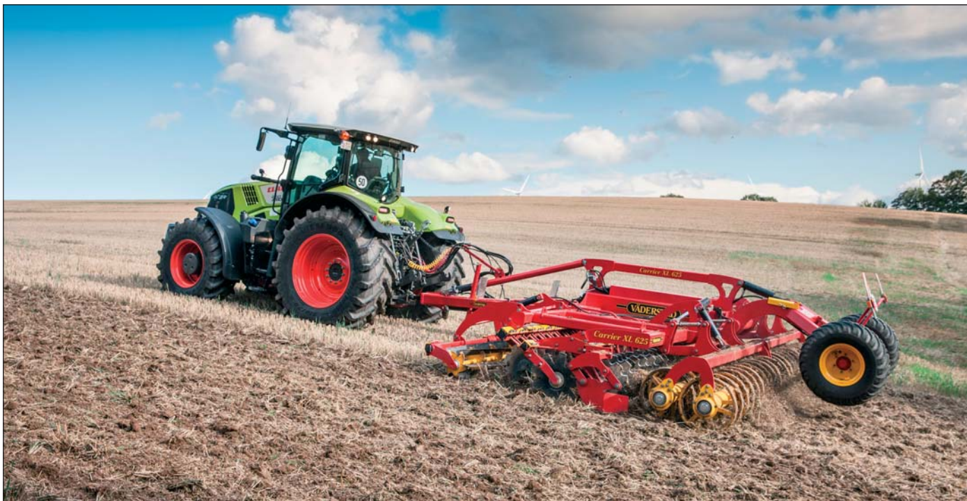
Väderstad Carrier XL 625 s diskami s priemerom až 61 cm. V ponuke sú pracovné zábery 425, 525, 625 a 825 cm.
