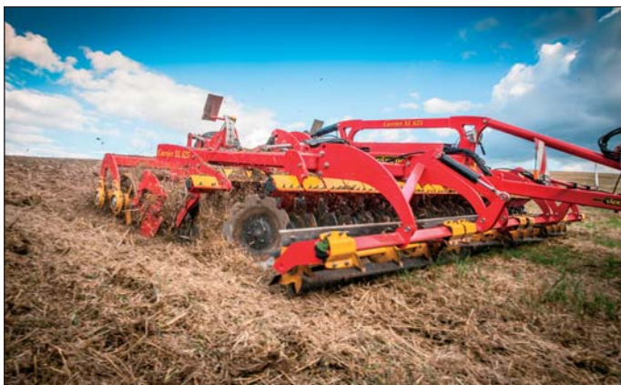
Vpredu na stroj je možné umiestniť CrossCutter, ktorý drví rastlinné zvyšky. Výsledkom je ich lepšie následné zapracovanie.
