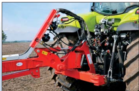
Tenzometrický snímač sily na hornom tiahle tento rok doplnili aj o snímanie sily na spodných ramenách.
