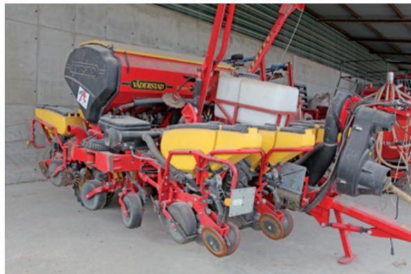
Výkon presnej sejačky Tempo F8 je pri priemernej rýchlosti 12 km/h, 80 až 85 ha za jeden deň.
