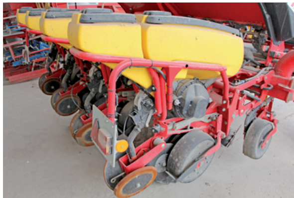
Každá výsevná jednotka je vybavená 70 l zásobníkom na osivo a 17 l zásobníkom na mikrogranulát.
