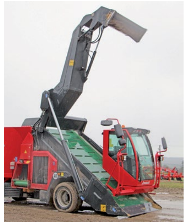
Výškový dosah ramena so štítom je 5,1 m, s korekciou uhla do výšky 4,5 m.
