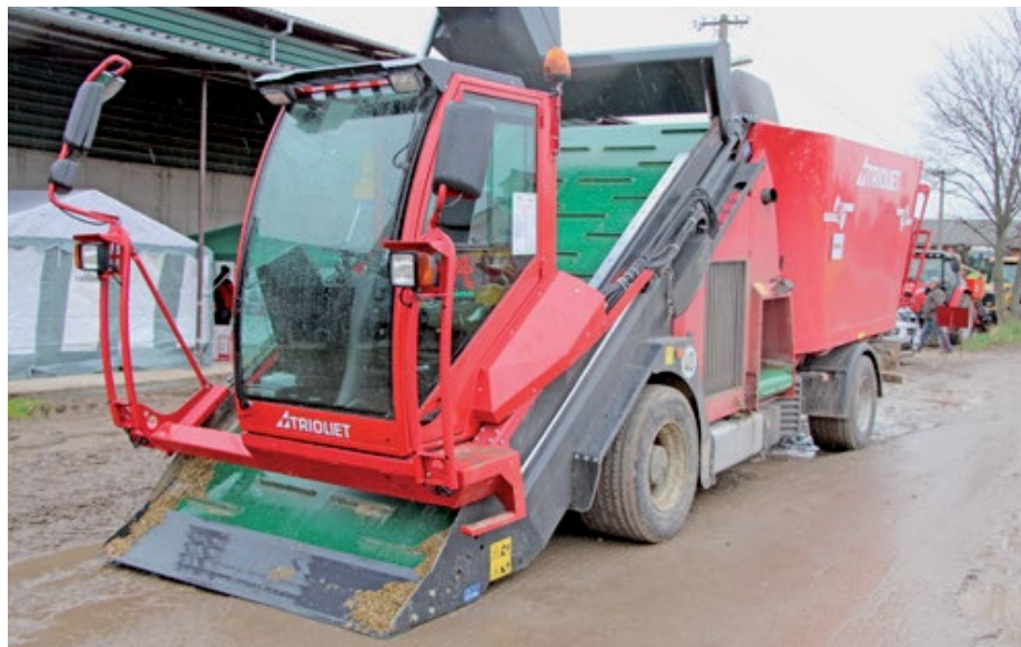
Konštrukčne je samostatný MKV postavený na ojedinelej koncepcii využívajúcej kombináciu vyrezávacieho štítu, podávacieho bubna a šikmého pásového dopravníka.
