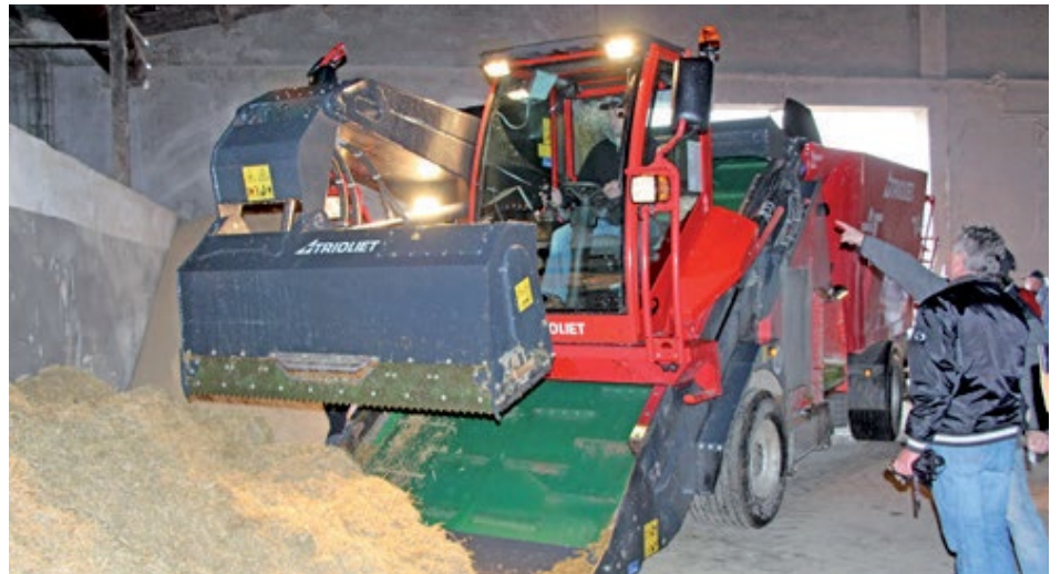
Šikmý dopravník je osadený na tenzometrických snímačoch váh, ktoré poskytujú informácie o hmotnosti naberanej zložky.
