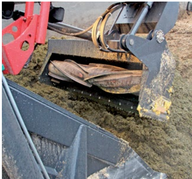
Na čelne umiestnenom ramene s vyrezávacím štítom sa nachádza tiež podávací bubon (nie fréza), ktorý oddelenú hmotu vrhá na pásový dopravník.
