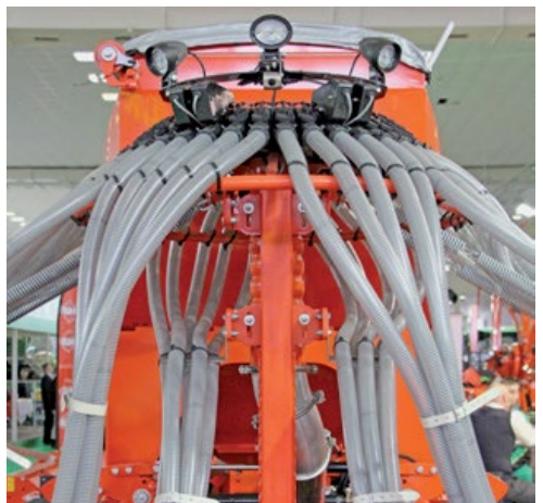
KUHNS Espro je vybavený LED osvetlením v zadnej časti, prednými svetlometmi a osvetlením vo vnútri zásobníka.
