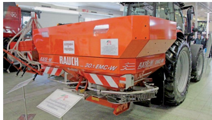
Agrisalónová výstavná slovenská premiéra malo dvojkotúčové rozmetadlo RAUCH AXIS 30.1 M-EMC + W s patentovaným vážiacim zariadením.
