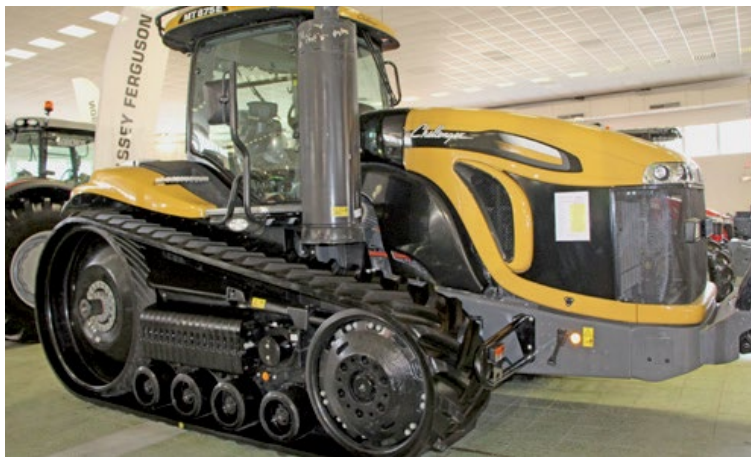
Pásový traktor Challenger MT 875 E využíva nový dvanásťvalcový motor AGCO Power.
