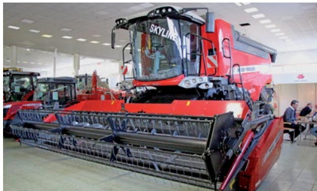
Massey Ferguson 7370 Beta používa mláťací bubon s priemerom 600 mm a šírkou 1,6 m, separačná plocha koša je takmer jeden meter štvorcový.
