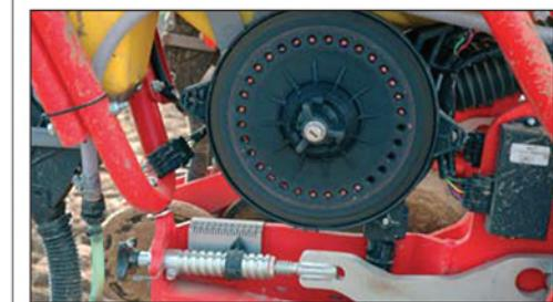
Sejačka pracuje presne vďaka elektrickému pohonu jednotiek a patentovanej výsevnej jednotke Gilstrip pracujúcej s pretlakom vzduchu.
