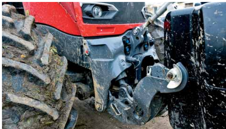
Predný vývodový hriadel' a dva okruhy hydrauliky v Pruskom žiadali pre prípadné núdzové nasadenie do žacej trojkombinácie.
