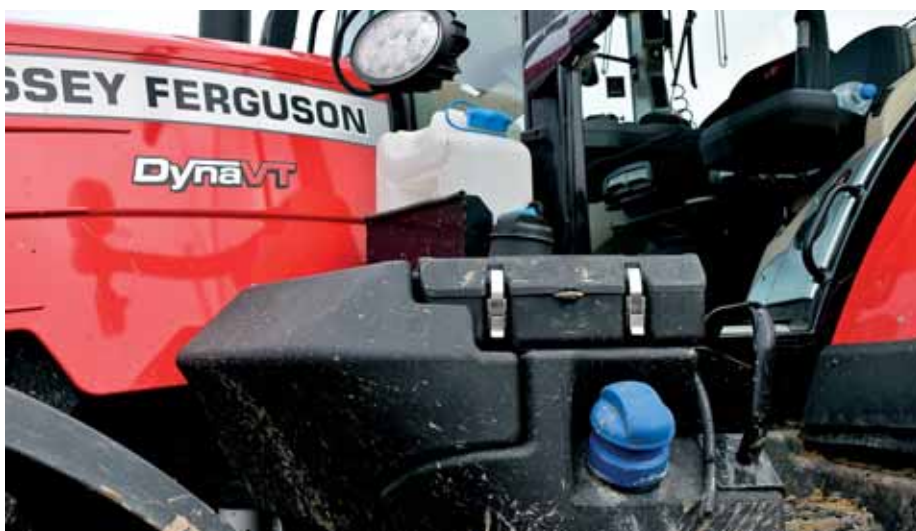
Traktor si dovybavili bandaskou na čistú vodu pre umývanie rúk. Domontovali aj kompresor pre vzduchové čistenie stroja.
