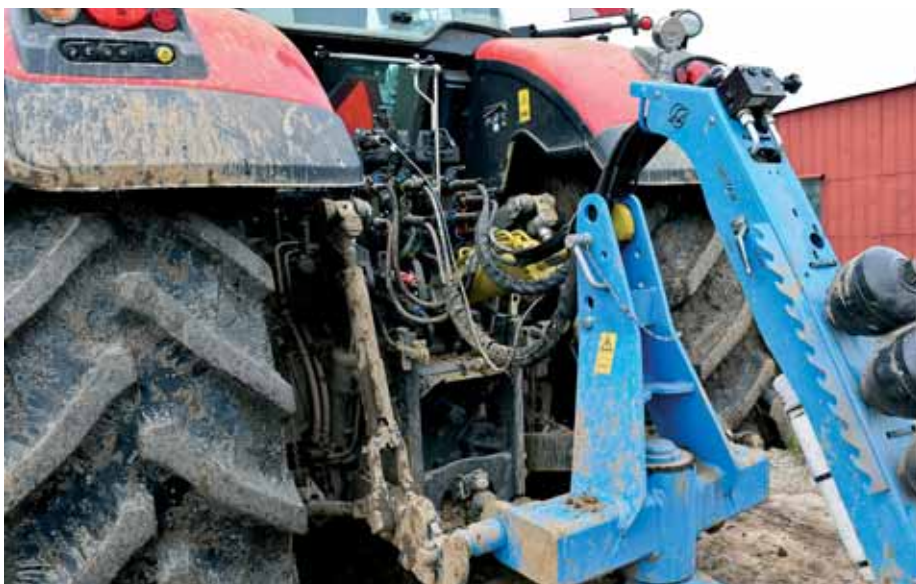
Hydraulickým tretím bodom závesu bola 8740-ka vybavená až po jej kúpe.
