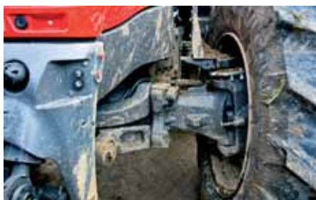
Odpružená predná náprava QuadLink je štandardom. SpeedSteer umožňuje zvoliť počet otáčok volantu pre vytočenie kolies prednej nápravy z jednej krajnej polohy do druhej. Uzavierka a pohon majú samozrejme automatické vypínanie pri rýchlosti nad 14 km za hodinu.
