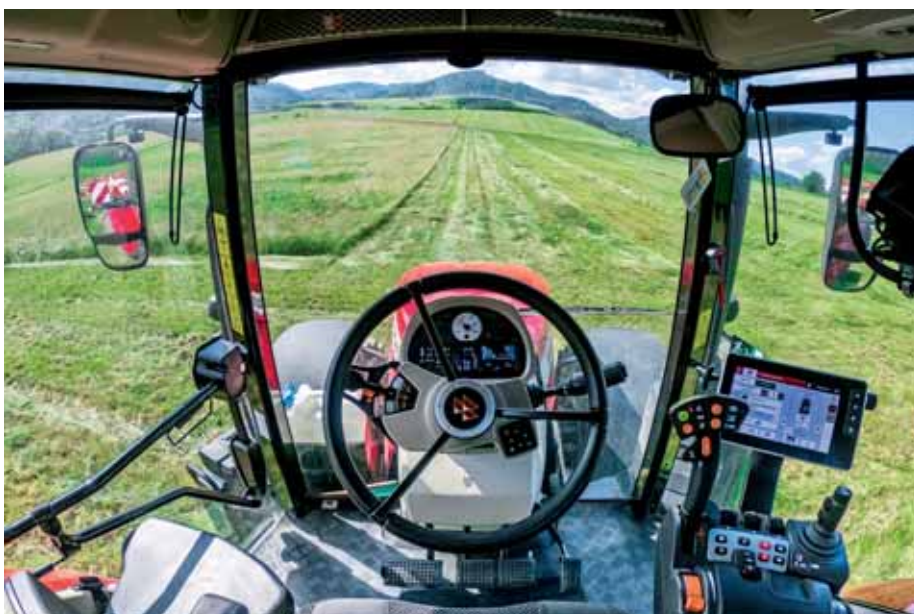
Nový displej Datatronic 5 s 9" obrazovkou zobrazí obraz z kamery, navigáciu, riadi IsoBus náradie a celý traktor.
