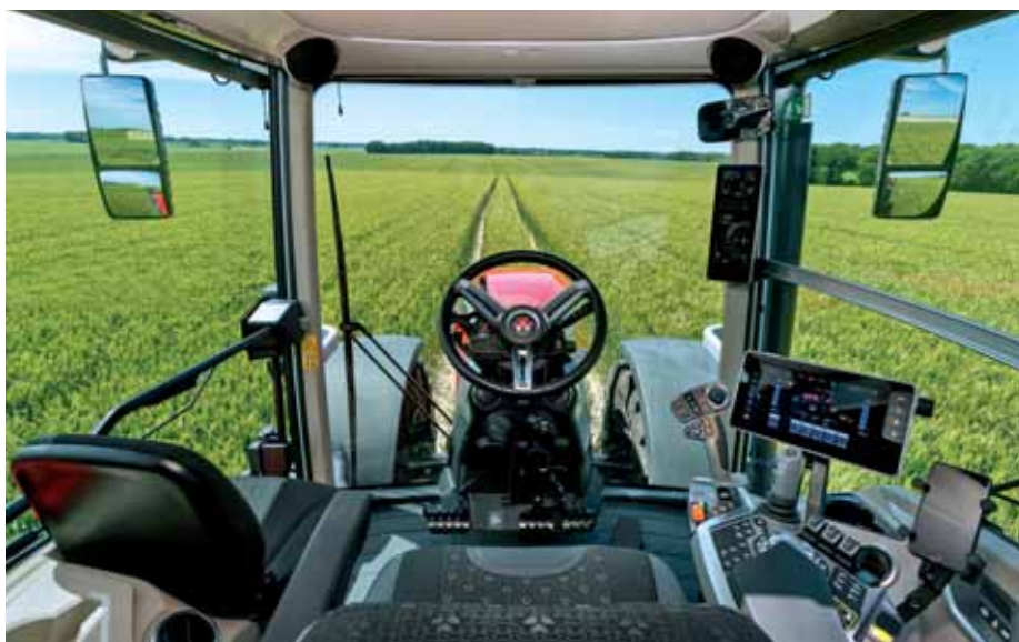
Pohľad z kabíny smerom dopredu je zlepšený vďaka malej SCR jednotke a stĺpiku riadenia bez palubnej dosky.
