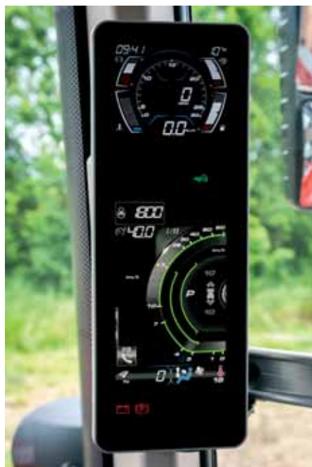
vDisplay na pravom A stĺpiku preberá úlohu palubnej dosky.
