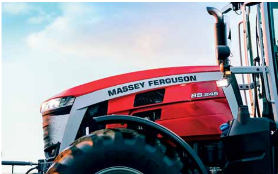
Medzera medzi motorovým priestorom a kapotou 24 cm charakterizuje rad, ale predovšetkým znižuje prienik hluku, vibrácií a tepla do kabíny.
