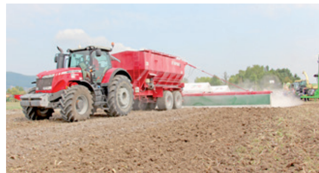
Predvedenia sa dočkal i ťahaný stroj na variabilnú aplikáciu vápna z dielne spoločnosti Agrottrade –AT Vápnar.
