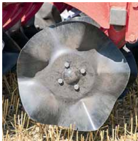
CrossCutter vymení počas jednej otočky smer jazdy desať razy.
