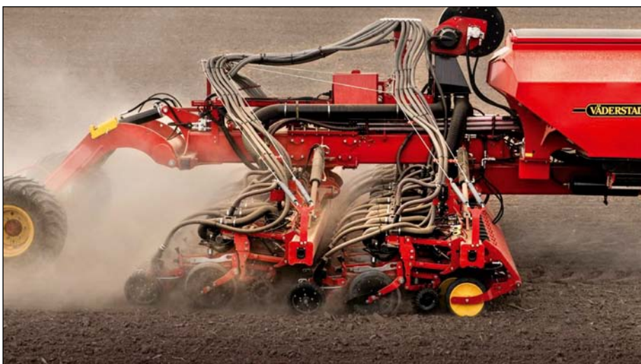
Prístupnosť k prednému radu pri výmene výsevnych kotúčov a počas servisu uľahčuje posun zadnej sekcie o 55 cm.
