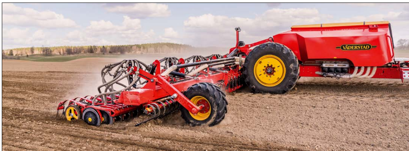
Inspire 12000 so záberom 12 m má zásobník pre osivo a hnojivo v objeme až 7 200 l.
