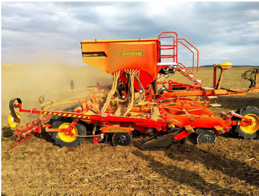
Rapid RDA 600 S so systémom Seed Eye pri presnej sejbě repky v PD Pribeta
