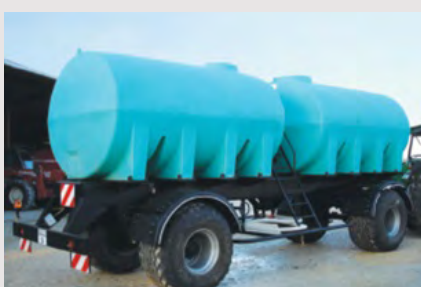
Miešacie zariadenia na rozpuštenie soli
