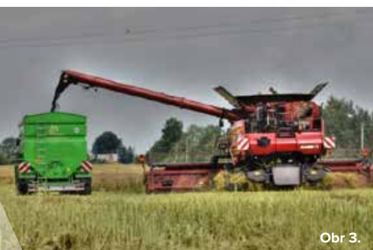
Obr 3. Plnenie prekladacieho voza GTU25 za jazdy
