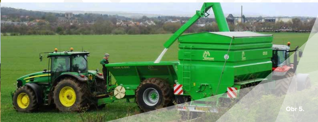
Obr 5. Využitie prekladacieho voza na plnenie rozmetadla (zvyšenie výkonu rozmetadla až o 50%)
