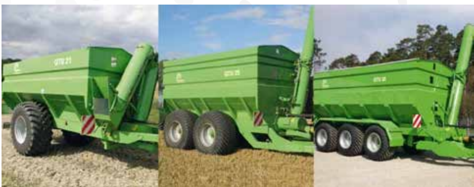
Tri typy a kapacity prekladacích vozov Gustrower GTU (od 21 m 3 až do 43
