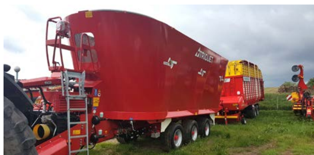
Najväčší krímny voz SOLOMIX 3 - vertikálne závitovky
