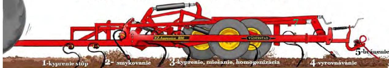
Predsejbové kultivátory NZ prinášajú bezkonkurenčnú presnosť prípravy sejbového lôžka, umožňujú skorší vstup do poľa po zime a rýchlejšiu, presnejšiu sejbu. S pracovnými zábermi pre každú veľkosť farmy od 5 m až do 14,5 m prinášajú až extrémnu kapacitu, výkon a úsporu nákladov. 5 operácií jedným prejazdom a 6. operáciu - valcovanie - je možné tiež doplniť. Čelný smyk presúva množstvo pôdy, drví hrudy a vyrovňáva profil. Radličky
