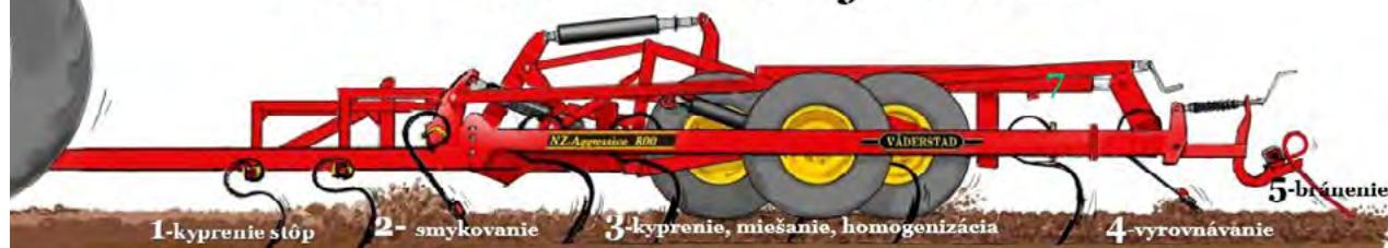
Predsejbové kultivátory NZ prinášajú bezkonkurenčnú presnosť prípravy sejbového lôžka, umožňujú skorší vstup do poľa po zime a rýchlejšiu, presnejšiu sejbu. S pracovnými zábermi pre každú veľkosť farmy od 5 m až do 14,5 m prinášajú až extrémnu kapacitu, výkon a úsporu nákladov. 5 operácií jedným prejazdom a 6. operáciu - valcovanie - je možné tiež doplniť. Čelný smyk presúva množstvo pôdy, drví hrudy a vyrovňáva profil. Radličky
