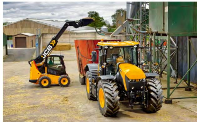
JCB ako prví navrhli koncept kolesového traktora **Fastrac v roku 1991**, známeho svojím unikátnym systémom plného odpruženia a najlepšieho prenosu výkonu na podložku. Stále jediný traktor, ktorý môže legálne jazdiť po cestách rýchlosťou **60 km/h s jazdnou súpravou 40 ton**. JCB dnes ponúka 3 modely série 4000 a 2 modely série 8000. Vďaka týmto strojom môžete **zlepšiť svoju produktivitu, zrýchliť pracovné operácie až o 25 %** vďaka rýchlosći.
