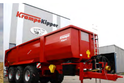
Náves s výtlačným systémom Krampe RamBody 900 a najväčší trojnápravový náves BiG Body 900 s objemom až 47 m 3
