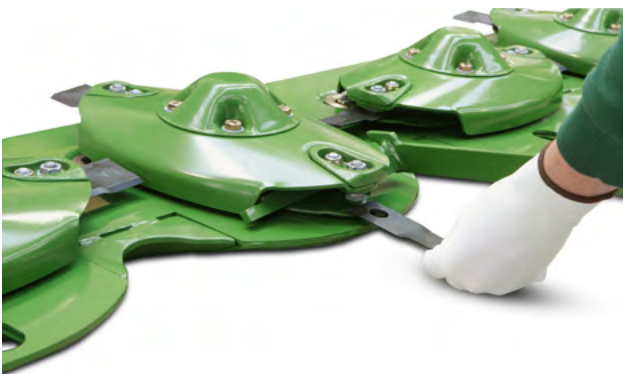
Žacia lišta KRONE - modulárny systém žacieho disku
