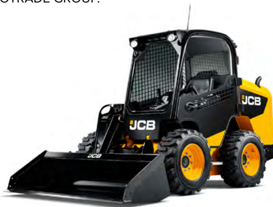
Jediný šmykon riadený nakladač s ramenom uloženým na pravej strane pre väčšiu bezpečnosť obsluhy
