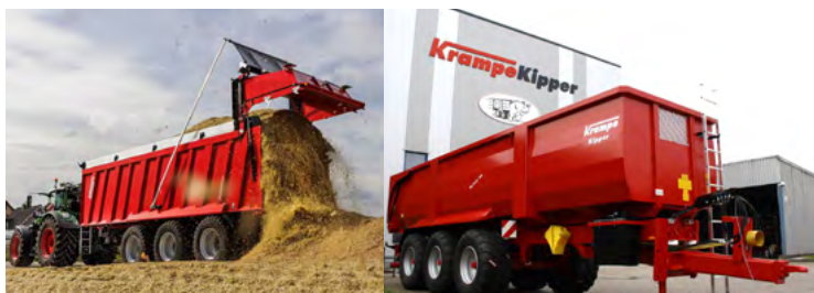
Náves s výtlačným systémom Krampe RamBody 900 a najväčší trojnápravový náves BiG Body 900 s objemom až 47 m 3
