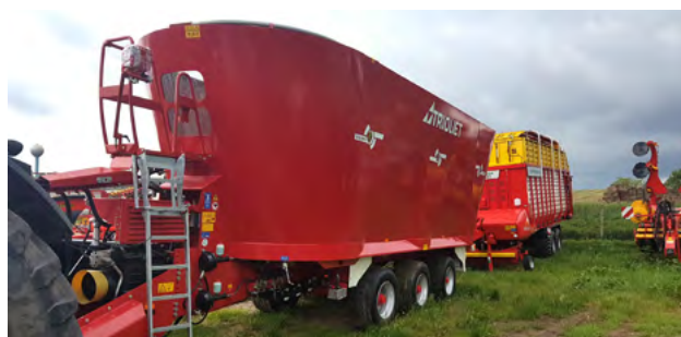
Najväčší krímny voz SOLOMIX 3 - vertikálne závitovky
