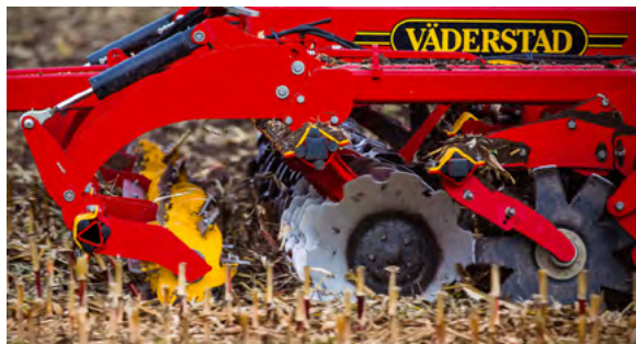
Carrier s čelným nožovým rotorom Crosscutter Knife
