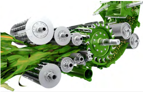
6 vkladacích valcov - jedinečný systém KRONE
