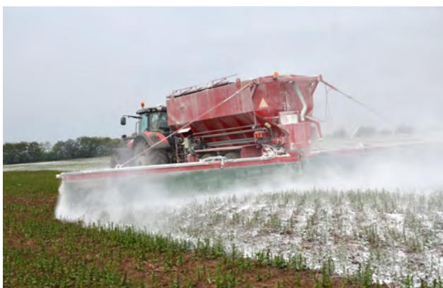
Variabilné a presné vápnenie pomocou KRAMPE SK 600
