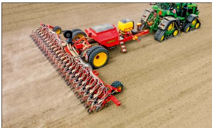
Sejací stroj na presný výsev Väderstad Tempo L24 s centrálnym zásobníkom. Vlastníkom stroja je od minulého roka PD Levice, patriace do skupiny Gamota. Ide o prvý stroj tohto typu dodaný na Slovensko.
