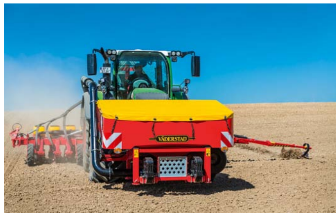
Väderstad ponúka aj riešenie zásobného hnojenia pre sejačky či pôdospracujúce stroje prostredníctvom svojho čelného zásobníka FH 2200. Možno však použiť aj zásobníky iných výrobcov. Na pravom snímku sa nachádza detail dodatočne namontovanej hnojnej pätky.
