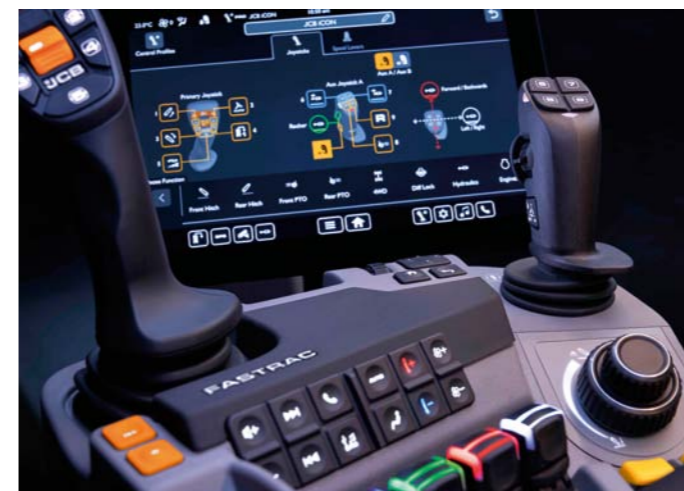
Konzola obsahuje nový hlavný joystick; priraditeľné RGB LED farebne označené páčky pre proporcionálne ovládanie hydraulických okruhov, ovládanie vývodového hriadeľa a trojbodového závesu. Nový menší pomocný joystick ovláda ďalšie hydraulické funkcie.
