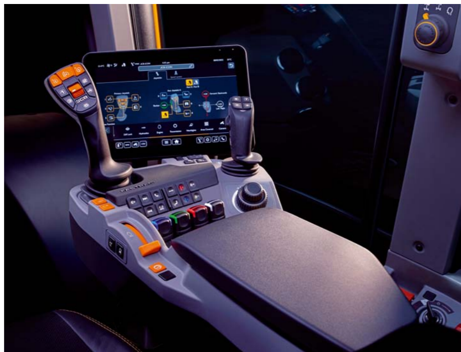
Nová laktová opierka má 12-palcový monitor, nový hlavný joystick a nový pomocný joystick. Palubnú dosku tvorí 7-palcový monitor.
