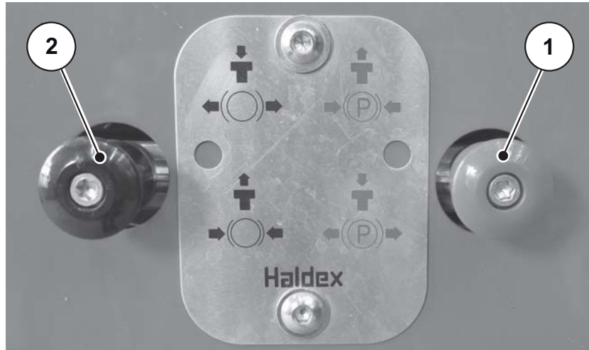
Obrázek 6.12: Odbrzdnění parkovací brzdy
