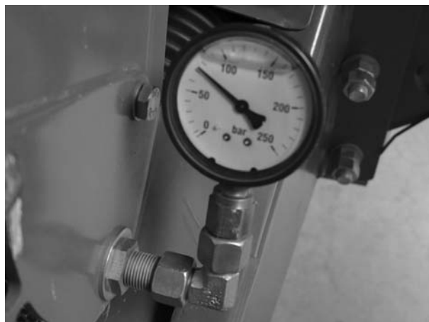
Obrázek 9.16: Manometr na kabelovém vedení nad ojí
