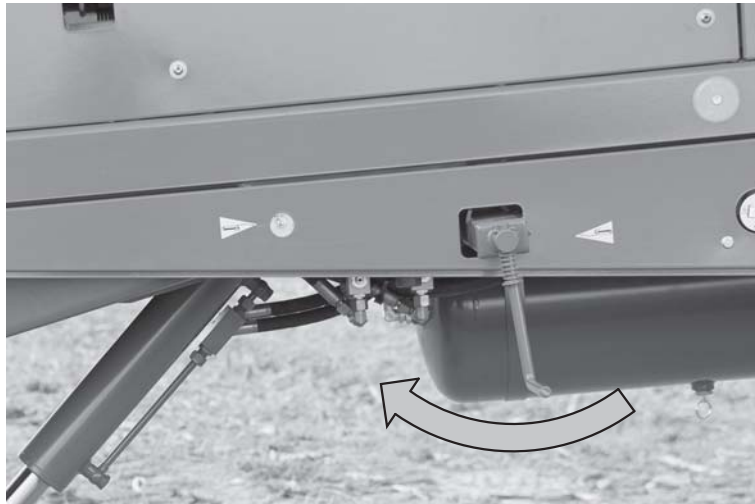
Obrázek 7.21: Ruční zatažení parkovací brzdy
