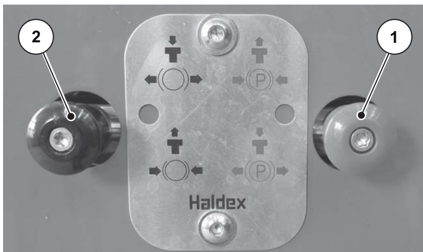
Obrázek 7.20: Ruční odbrzdění parkovací brzdy
