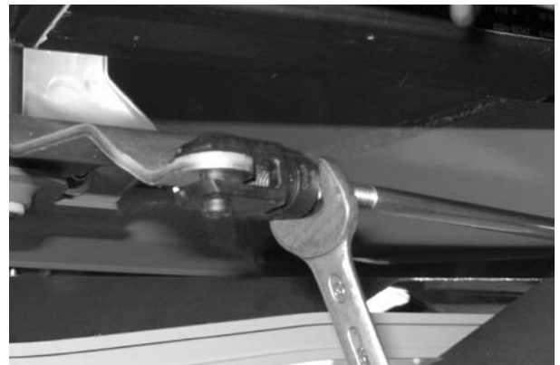
Obrázok 9.19: Zaveste vnútornú hlavu ojnice
