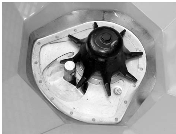
Obrázok 9.13: Čap dolného ramena nápravy v dávkovacom otvore
