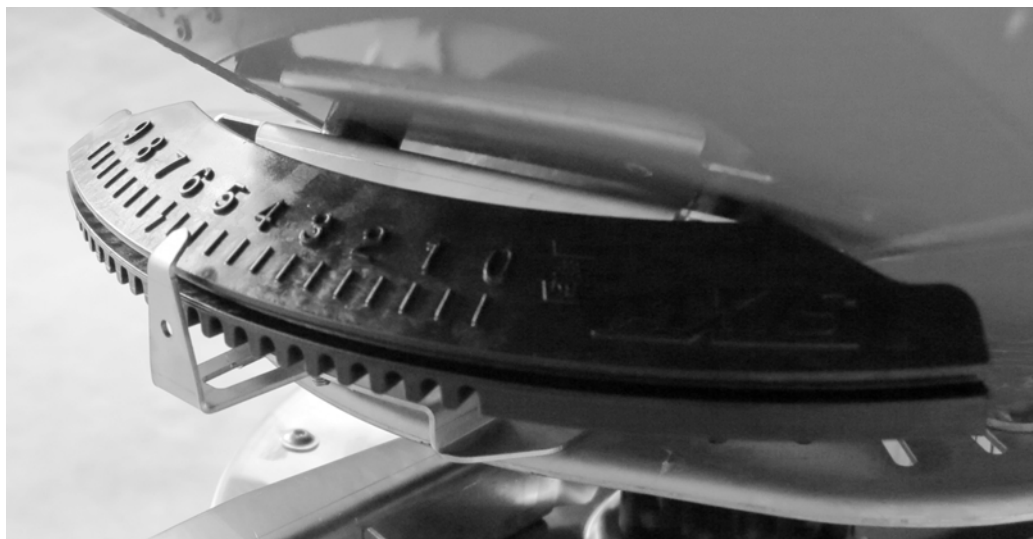
Obrázok 8.5: Centrálné miesto na nastavenie bodu dávkovania
