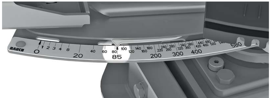
Obrázok 9.16: Ukazovateľ dávkovacieho posúvača na polohe 85
