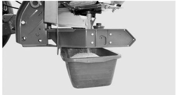
Obrázok 8.15: Vykonanie skúšobného rozmetávania
