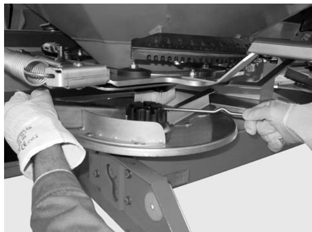
Obrázok 8.3: Uvoľnenie uzavretej matice
