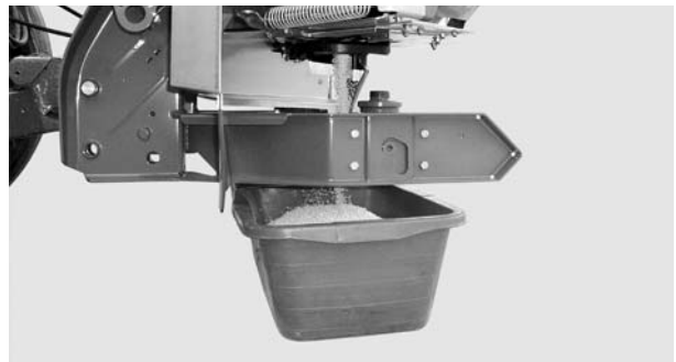
Obrázok 8.14: Vykonanie skúšobného rozmetávania
