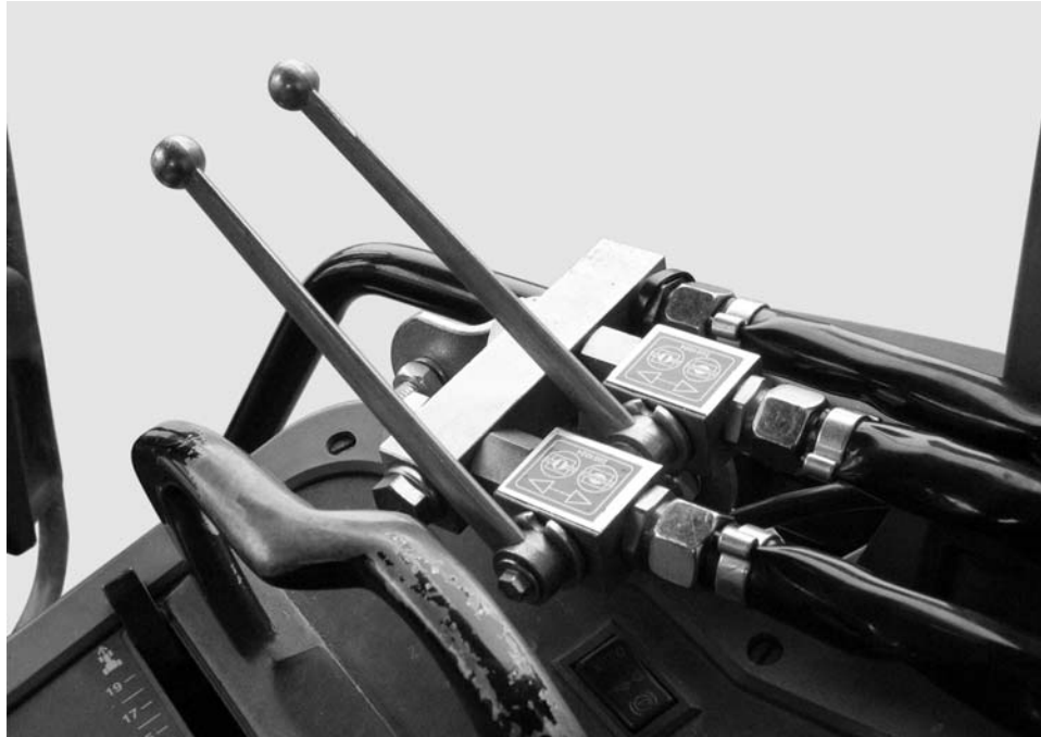
Obrázok 7.12: Ovládanie posúvača dvojcestnej jednotky
