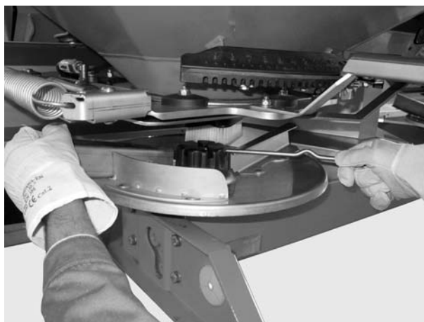
Obrázok 8.12: Uvoľnenie uzavretej matice
