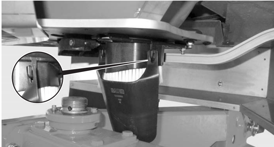
Obrázok 8.13: Zavesenie sklzného žľabu na skúšobné rozmetávanie
