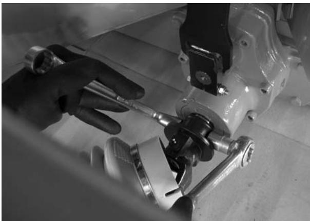
Obrázok 7.4: Upevnenie kĺbového hriadeľa
