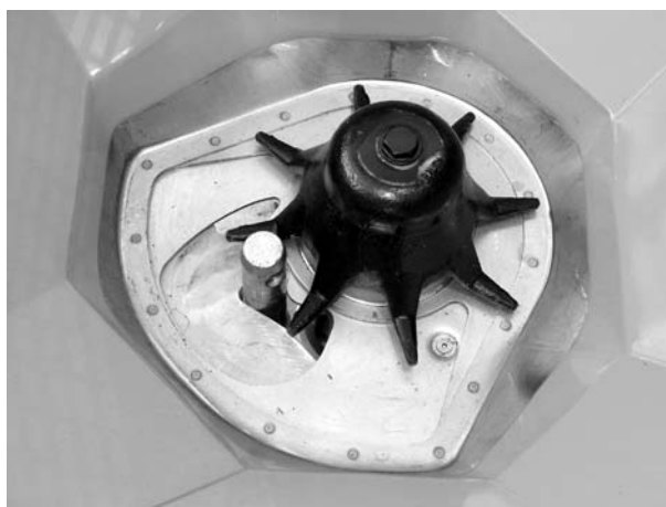
Obrázok 10.14: Čap dolného ramena v dávkovacom otvore
