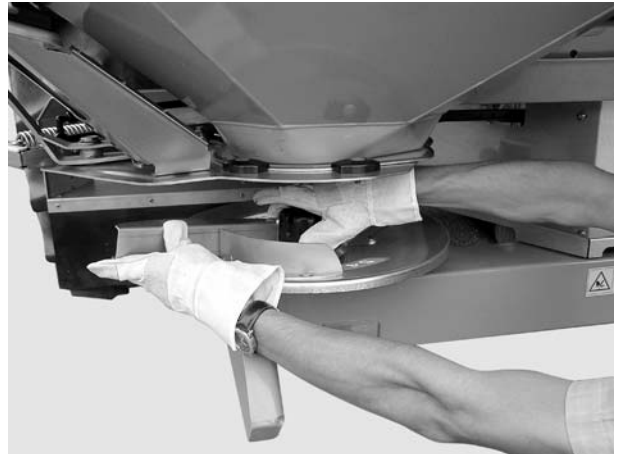
Obrázok 8.15: Zaskrutkovanie uzavretej matice
