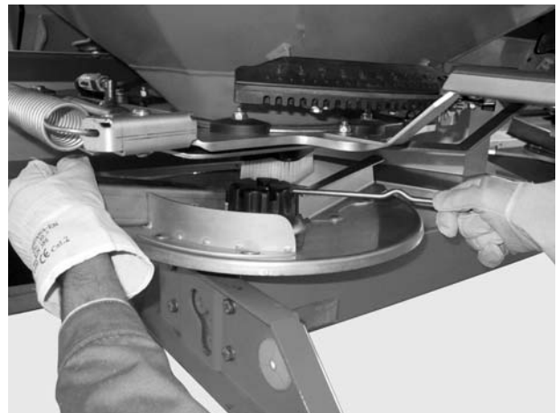
Obrázok 8.13: Uvoľnenie uzavretej matice
