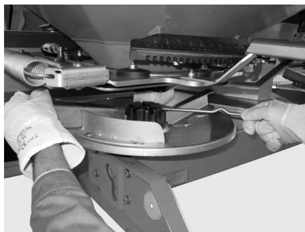
Obrázok 8.3: Uvoľnenie uzavretej matice
