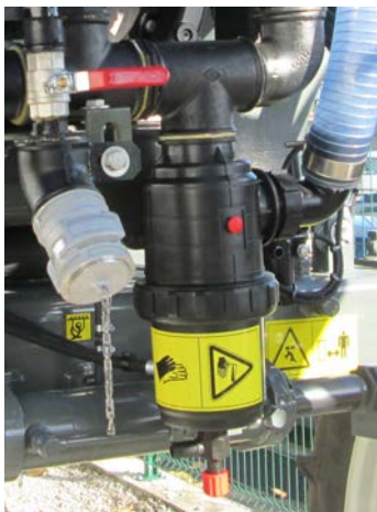
Obrázek 7.11. Demontujte spodní část filtru
