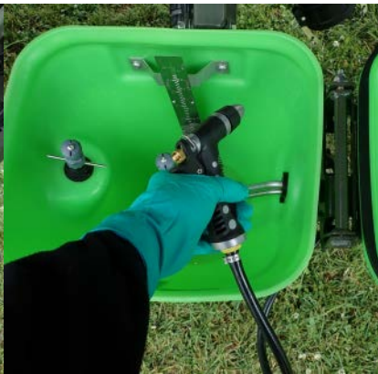
Obrázek 6.47. Proplachování násypníku pistolí
