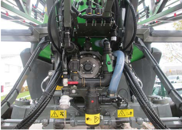
Obrázek 6.70. Přístup k čerpadlu je v zadní části nosného vozidla.
