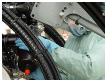
Obrázek 7.10. Demontujte spodní část filtru
