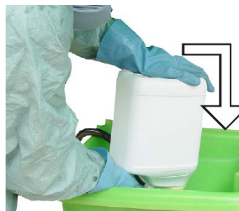
Obrázek 6.42. Pečlivě vypláchněte prázdnou nádobu od produktu
