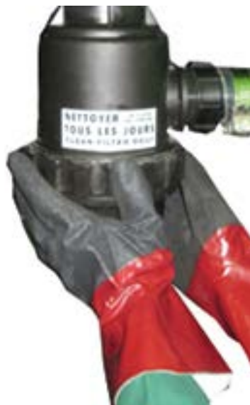
Obrázek 7.29. Demontujte spodní část filtru
