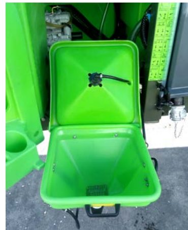
Obrázek 6.35. Rozložený zásobník v poloze pro přimíchávání (sejmuté víko)
