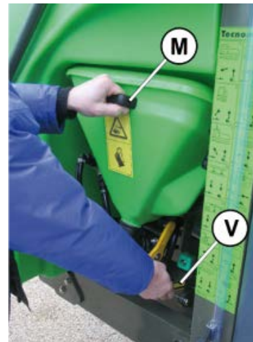
Obrázek 6.30. Odemknutí zámku V. Obrázek 6.31. Nasazením zámku V.
