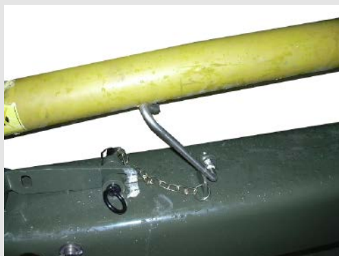
Obrázek 5.29. Kardanovou hřídel o jeho podporu.
