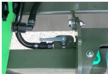
Obrázek 7.38. mísící ventil v otevřené poloze
