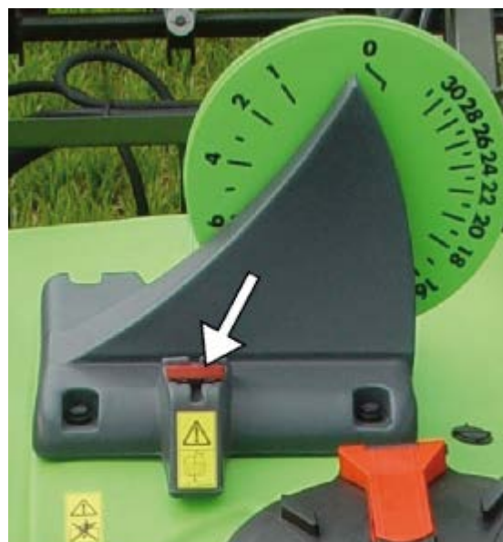
Obrázek 6.75. Ovládání vyprazdňování nádrže
