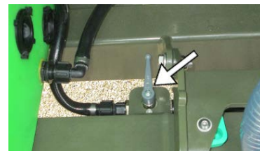
Obrázek 6.73. ventil pro regulaci míchání
