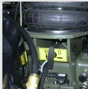
Obrázek 6.136. Rukojeť v silniční poloze (neutralizována funkce vlečené nápravy )
