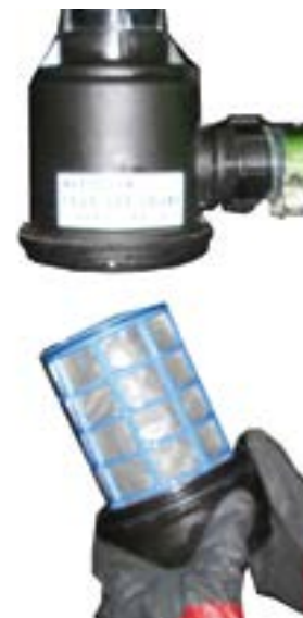
Obrázek 7.30. Demontujte spodní část filtru
