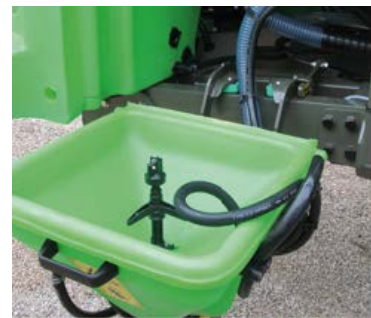
Obrázek 6.40. Nálevka je rozložena v poloze proplachování nádoby (LAV'BOX)
