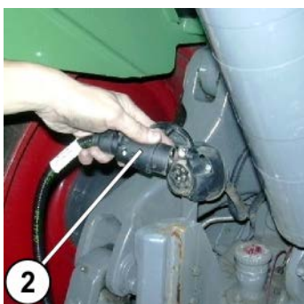
Obrázek 5.37. Napájecí kabely dálkových světel
