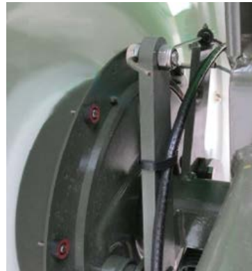
Obrázek 6.128. Pojistné matice brzdová lanka
