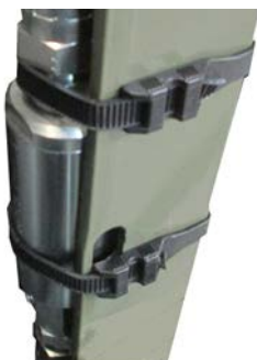
Obrázek 7.15. Možnost DC2, filtr je namontován, umístěn na levém rámu hydraulického bloku
